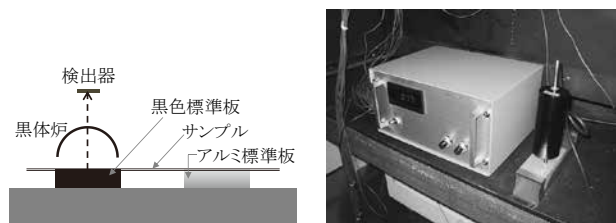
図3 長波放射透過率の測定
